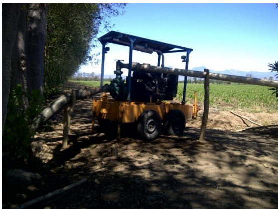
Fotografía 1. Bomba utilizada para extracciones del zanjón el Aguacate para el riego por aspersión de la plantilla renacida de Caña de Azúcar tal como se observa
